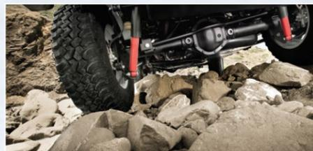
**DIFFÉRENTIELS TRU-LOK<sup>MD</sup>** Les différentiels verrouillables électroniques avant et arrière Tru-Lok équilibrent la vitesse entre les roues gauches et droites pour permettre de maintenir l'élan du véhicule et de profiter d'une adhérence maximale. Une commande à bascule montée sur le tableau de bord permet de verrouiller l'essieu arrière ou les deux essieux. (De série sur le Rubicon<sup>MD</sup>)
